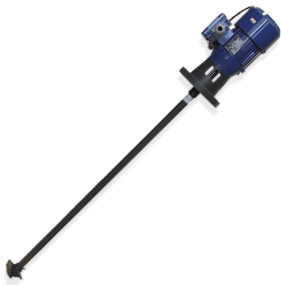
MIXVN/8 Agitador rápido. 1400 RPM. Eixo em aço inoxidável revestido em PVC, comprimento variável (630-730-830-930 mm). Pá marinha, diâmetro 70 mm.
