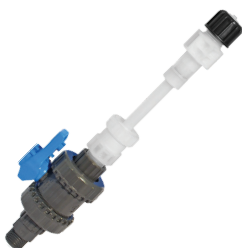
LINIR Lança injetora de 1/2" para a dosagem de hipoclorito de sódio na presença de água dura. Injetor autolimpante. Anel O-ring em Viton®. Corpo em PVC.
