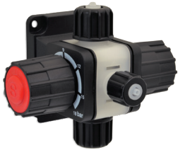
MF VÁLVULA MULTIFUNÇÃO Válvula multifunção (pressão, segurança, antissifão e descarga) com uniões de 1/2" adaptáveis a tubos de diferentes diâmetros. Anel O-ring em FKM B ou EPDM. Corpo em PVDF.
