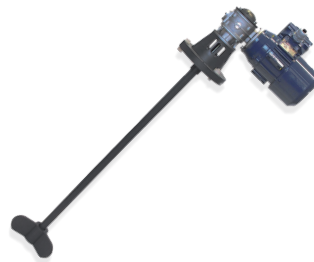
MIXN/8 Agitador lento. 70 / 200 RPM. Eixo em aço inoxidável revestido em PVC, comprimento variável (630-730-830-930 mm). Pá de 3 lâminas, diâmetro 150 mm.
