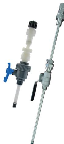
Lancia iniezione da 1/2" per il dosaggio di sodio ipoclorito in acqua potabile. Sistema di pulizia automatico, o-ring in FKM e corpo in PVC.
