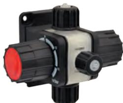
Valvole multifunzione per: pressione, sicurezza, anti-sifone, scarico. Campo di regolazione valvola di sicurezza: da 1 a 18 bar. Campo di regolazione valvola di pressione: da 1 a 5 bar. Raccordi di mandata e giunzione adattabile a tubi di diverso diametro. Corpo in PVDF e o-ring in FKM B o EPDM.
