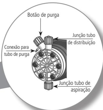
TMSA MF - detalhe do corpo da bomba com purga automática
