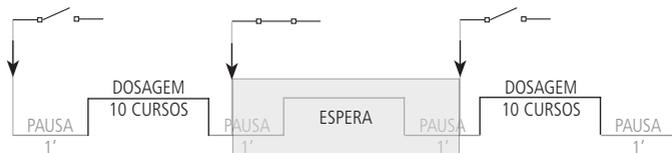
Fig. 26. Batch -mode internal- modalidade de trabalho da bomba com ciclo de pausa-trabalho regulado por um contato externo. Caso 2.
