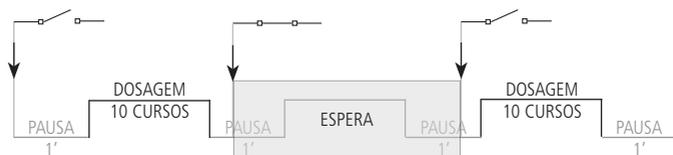
Fig. 24. Batch -mode internal- modalidade de trabalho da bomba com ciclo de pausa-trabalho regulado por um contato externo. Caso 2.
