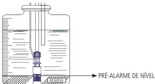
Em caso de ativação do pré-alarme, a bomba continuará as operações de dosagem mas na tela será exibido o símbolo # (ALARM LEVEL - **ALARMES**):
