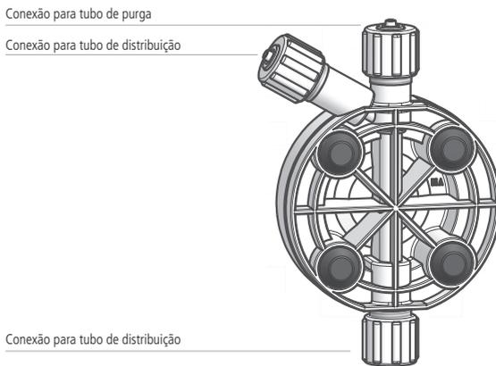
Fig. 10. Descrição do corpo da bomba com purga automática modelos: SA, TA (bomba AMSA MF).
