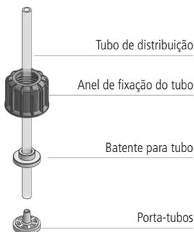
Aperte o tubo no corpo da bomba agindo no anel de fixação **apenas com as mãos**.
