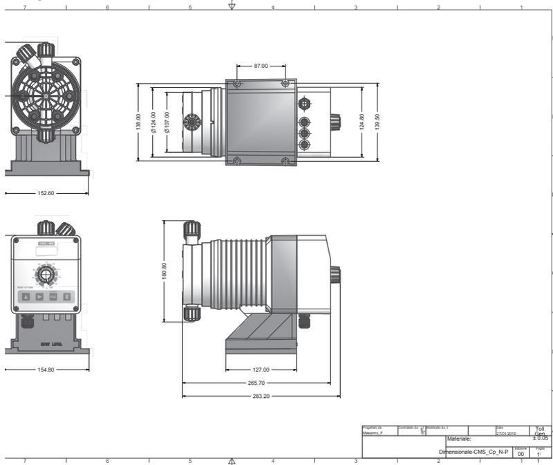
Fig. 51. Dimensões da bomba com corpo mod. S ou T
