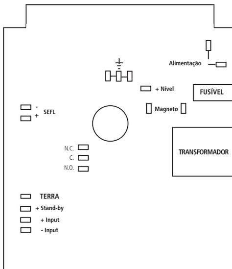
Fig. 46. Esquema do circuito modelo AMS MF para a ligação a um contador emissor de pulsos de efeito Hall
