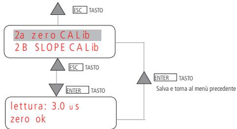
Selezionare "2B SLOPE CALIB" per calibrare lo Slope. Impostare il valore della soluzione tampone (da 0 a 99.9  $\mu$ S). Inserire la sonda nella soluzione tampone. Attendere che il valore letto si stabilizzi e premere ENTER per salvare ed uscire, oppure ESC per uscire senza salvare.
