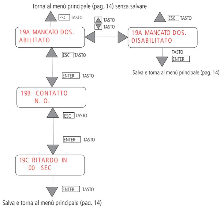
In presenza di un allarme dalla pompa dosatrice, se questo ingresso è abilitato, lo strumento visualizza il messaggio: "IMPIANTO ATTESA - MANCATO DOSAGGIO" e si attiva l'uscita allarme.
