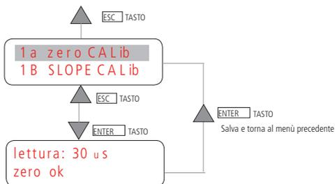
Selezionare "1B SLOPE CALIB" per calibrare lo Slope. Impostare il valore della soluzione tampone (da 0 a 999  $\mu\text{s}$ ). Inserire la sonda nella soluzione tampone. Attendere che il valore letto si stabilizzi e premere ENTER per salvare ed uscire, oppure ESC per uscire senza salvare.
