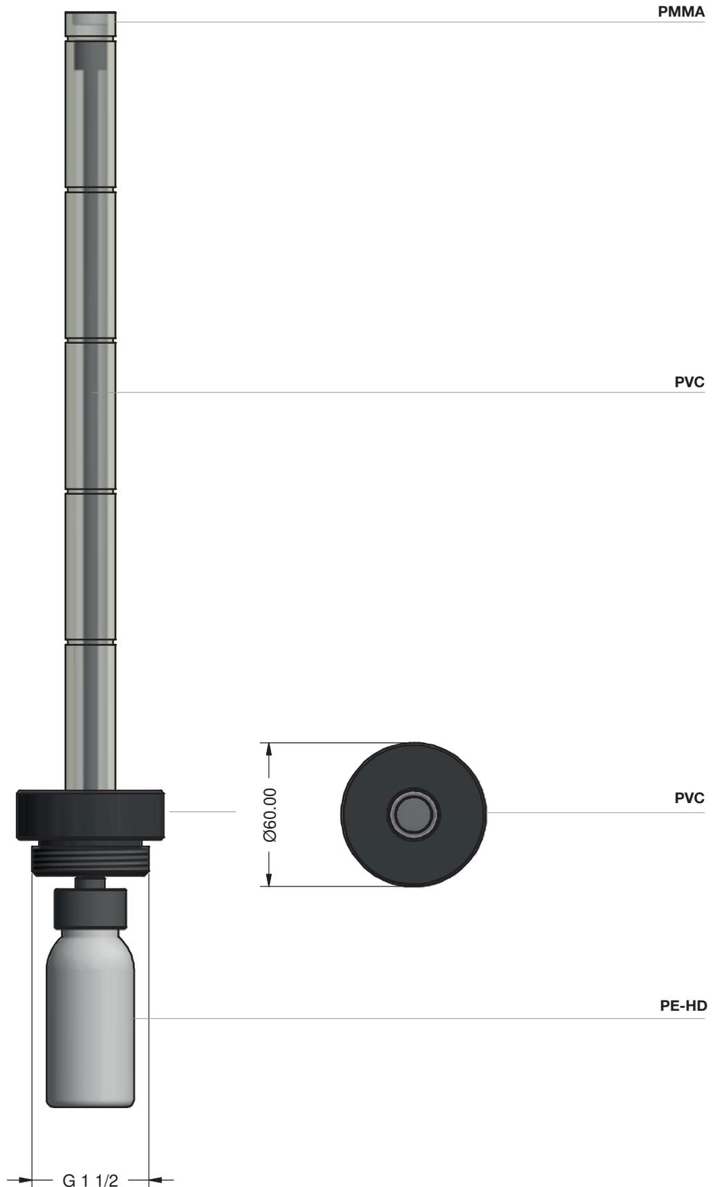
L'altezza dell'asta di rilevamento varia a seconda del CNT in uso
