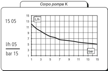
Tutte le indicazioni di portata sono riferite a misure effettuate con H<sub>2</sub>O a 20°C e alla contropressione indicata. La precisione di dosaggio è del  $\pm 2\%$  ad una pressione costante di  $\pm 0,5$  bar.
