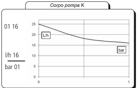
Tutte le indicazioni di portata sono riferite a misure effettuate con H<sub>2</sub>O a 20°C e alla contropressione indicata. La precisione di dosaggio è del ± 2% ad una pressione costante di ± 0,5 bar.
