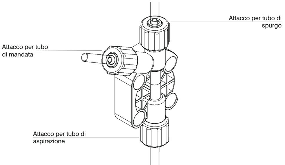
L'utilizzo di un corpo pompa autospurgo è necessario per il dosaggio di prodotti chimici che generano gas (es.: perossido di idrogeno, ammoniaca, ipoclorito di sodio a determinate temperature).
