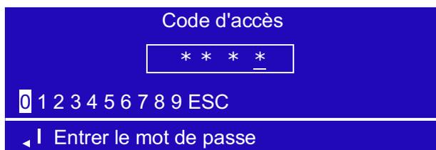
Sélectionner un code numérique à quatre chiffres. Dès que le quatrième chiffre est sélectionné, le menu principal s'ouvre automatiquement.
