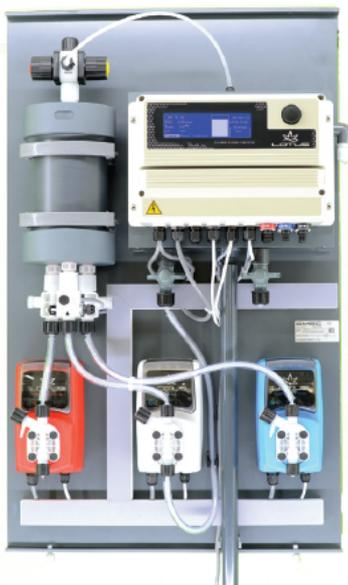
Le système LOTUS produit injecte et régle l'injection de dioxyde de chlore dans les installations de désinfections d'eaux. Le dioxyde de chlore étant obtenu à partir d'une réaction chimique de deux produits chimiques dilués : l'acide chlorhydrique (HCl 9%) et du chlorite de sodium (NaClO<sub>2</sub> 7.5%).
