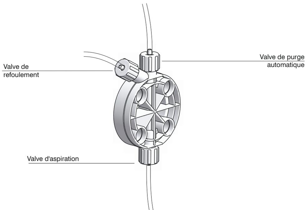
L'utilisation d'un corps de pompe à purge automatique est nécessaire pour le dosage de produits chimiques qui génèrent des gaz (par ex. peroxyde d'hydrogène, ammoniac, hypochlorite de sodium à certaines températures).
