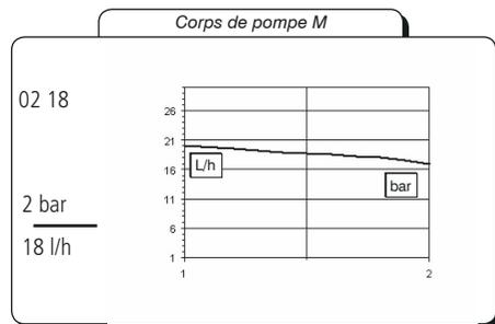
Toutes les indications de débit se réfèrent à des mesures effectuées avec H<sub>2</sub>O à 20°C et à la contrepression indiquée. La précision de dosage est de ± 2% à une pression constante de ± 0,5 bar.
