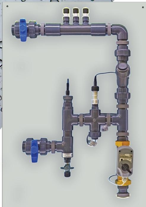
Der Rohrverteiler ist ein hydraulischer, auf einer Platte angeordneter Kreislauf, der eine standardisierte Installation ermöglicht, um die Lernzeit, die Ausführungszeit und die damit verbundenen Fehler zu reduzieren. Dadurch wird die Qualität der zu realisierenden Anlage vereinfacht und verbessert, wobei die Installationskosten durch die individuelle Planung vor Ort und die damit verbundene Suche nach den zu verwendenden Materialien deutlich reduziert werden.
