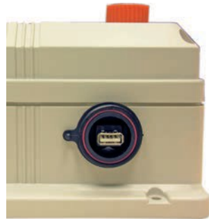
Den Stick in die USB-Verbindungsbuchse stecken (rechte Seite des Geräts) Nach dem Gebrauch den Stick wieder mit seiner Kappe abdecken
