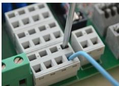
Die Drähte in den Klemmen "Stromversorgung und Relais" sollten unten eingesteckt werden, nachdem die Spitze eines Schraubendrehers oben eingesteckt wurde.
