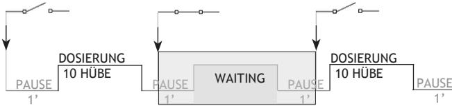
Abb. 21. Batch -Modus intern - Betriebsmodus der Pumpe mit Pausenzyklus gesteuert durch einen externen Kontakt. Fall 2.
