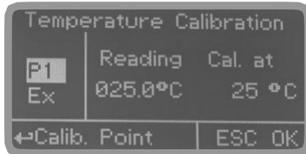
**Warnung:** Dieses Verfahren setzt voraus, dass das Instrument korrekt konfiguriert, an eine funktionierende PT100-Sonde angeschlossen und auf dem System installiert ist. Die Messung muss mit Wasser aus dem System durchgeführt werden. Andernfalls sind die Ergebnisse möglicherweise nicht zuverlässig.
