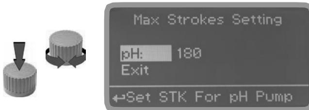
**ACHTUNG:** Die Dosierleistung der Pumpe basiert auf 180 Impulsen pro Minute.
