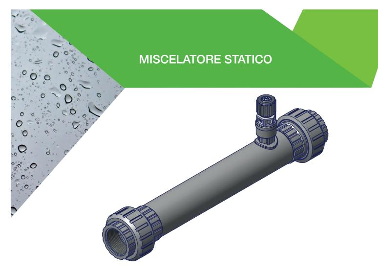
Miscelatori in PVC con iniezione progettati per la miscelazione di sostanze chimiche con bassa viscosità in un corso d'acqua. Il miscelatore è costruito in PVC con diverse dimensioni ed è riempito con elementi di miscelazione in PP. Gli elementi di miscelazione sono anelli Pall (diam. 15) per ridurre al minimo la perdita di pressione di miscelazione.
